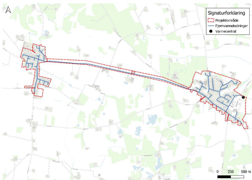
Figur 1 – oversigtskort over projektområdet for Vonge og Kollemorten Fællesvarme a.m.b.a. med indtegnet ledningstrace og placering af varmecentral
